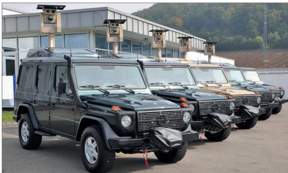
Zur mobilen Grenzüberwachung werden Fahrzeuge mit ausfahrbaren Sensorköpfen ausgestattet.
